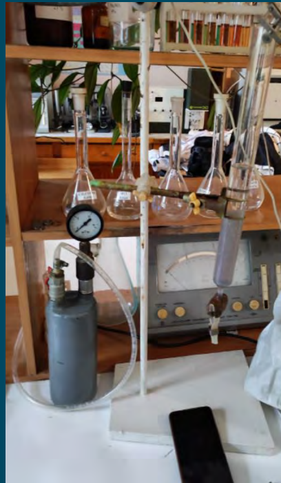
Лабораторний пристрій для видалення іонів амонію з води
