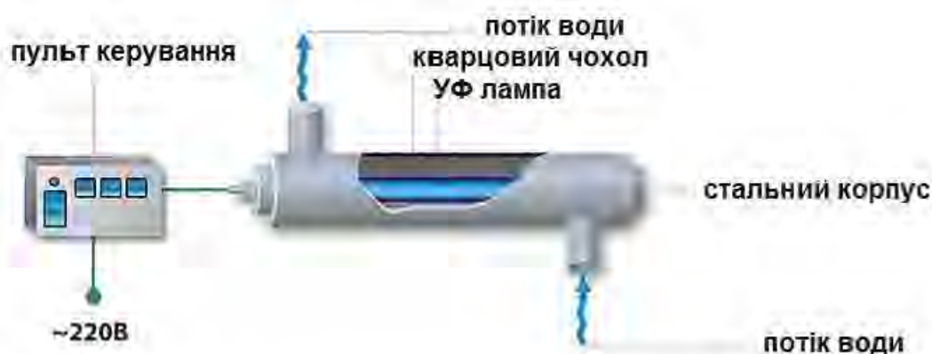
Рис.5.19. Схема ультрафіолетової установки
