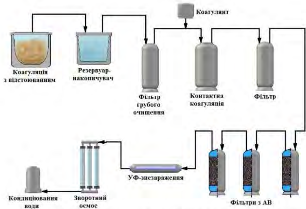
рис. 5.14. Схема підготовки питної води з поверхневого джерела в Великобританії
