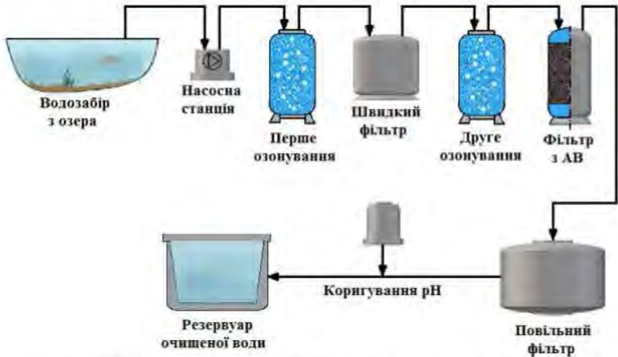
Рис.5.13. Приклад схеми безхлороної технології підготовки води питної якості (Цюріхські озера)
