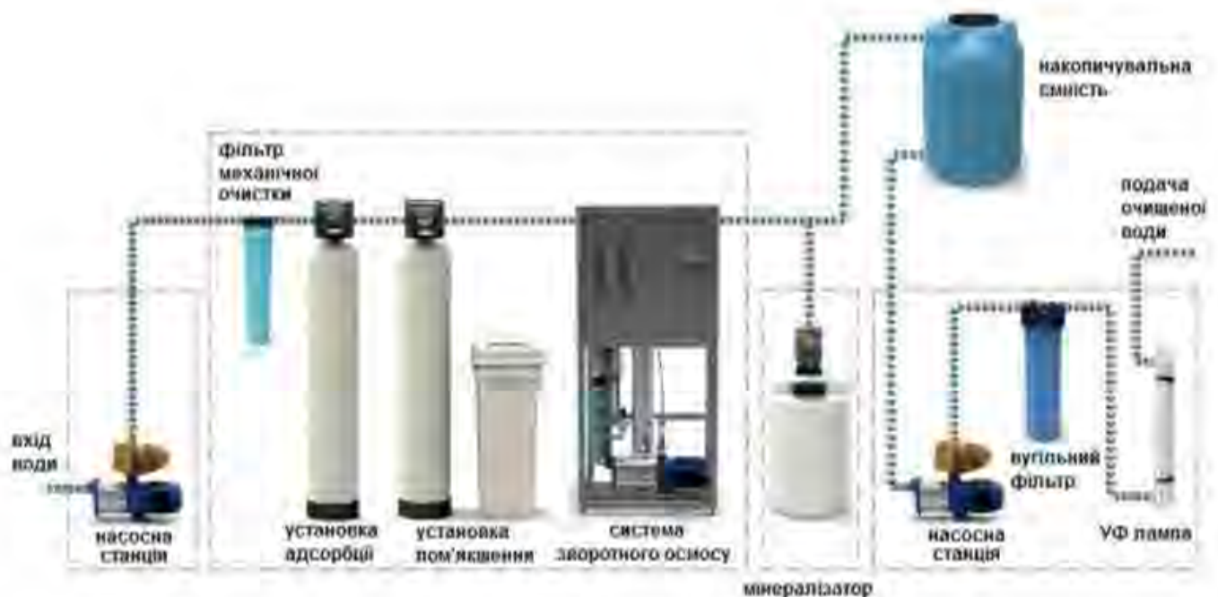
Рис. 5.21. Очистка води зворотнім осмосом
