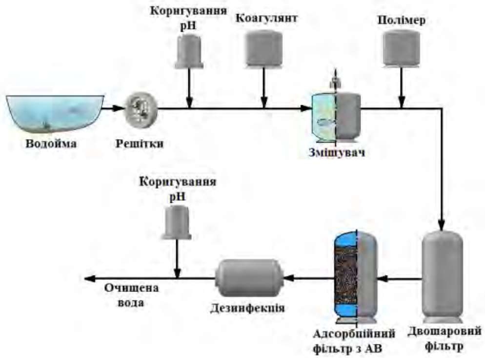
Рис. 5.8. Схема традиційного процесу водопідготовки з прямою фільтрацією при водозаборі з поверхневих джерел
