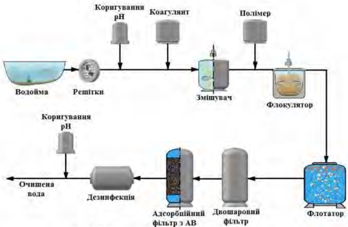
Рис. 5.7. Схема традиційного процесу водопідготовки з флотацією при водозаборі з поверхневих джерел
