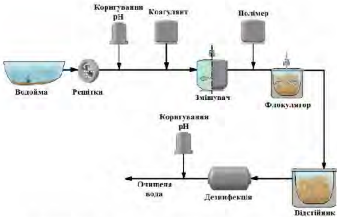
Рис.5.6. Схема традиційного процесу водопідготовки без фільтрації при водозаборі з поверхневих джерел
